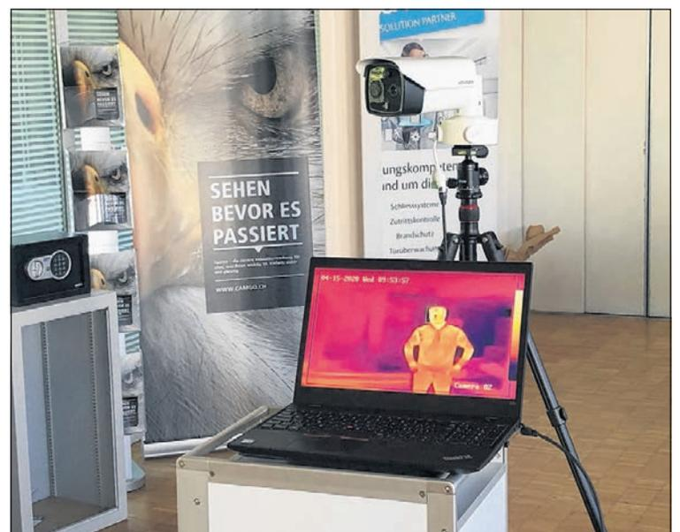
Die Thermalkameras im Einsatz bei der Birsfelder Firma Bürgi.com. Die Kamera gibt es als Handgerät oder – wie hier im Bild – auf einem Stativ montiert. Die Screening-Kameras können mehrere Personen gleichzeitig erfassen und messen mögliches Fieber innert einer Sekunde.
