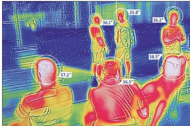
Bis auf 0,3 Grad Celsius genau messen die Thermalkameras Fieber bei Menschen aus fünf Metern Distanz.
