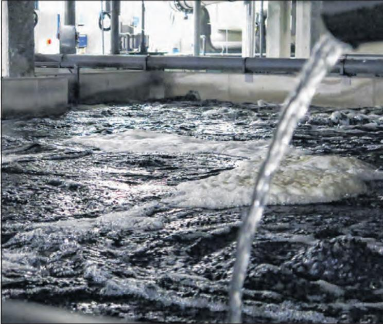
Mit einem Biofilter wird das aus dem Stoffwechsel der Fische stammende giftige Ammonium in harmloses Nitrat umgewandelt.
