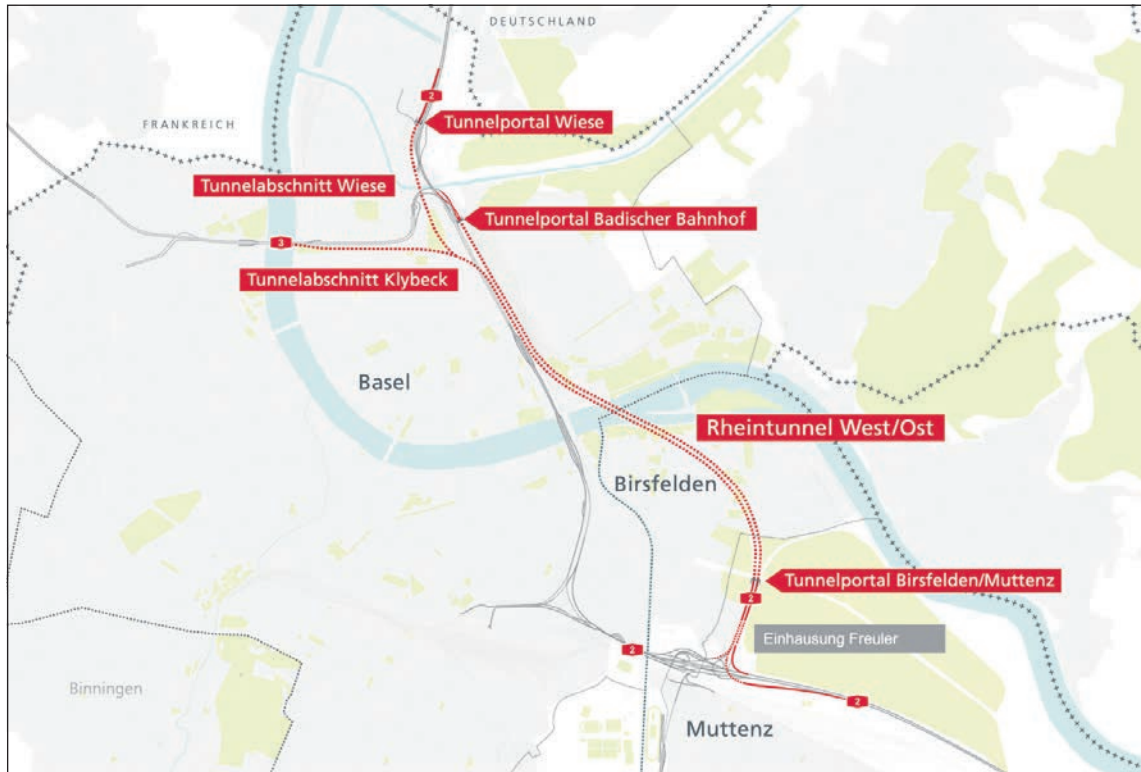
Der Verlauf des Rheintunnels (rote Linie): Gestrichelt die unterirdischen oder überdachten Streckenführungen, durchgehend die oberirdischen.
