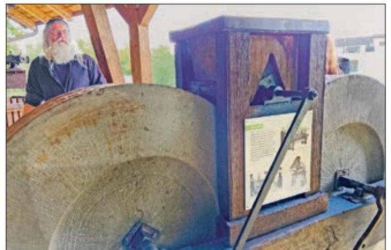
Um Birnel herzustellen, müssen die Birnen zuerst in einer grossen Obstmühle (rechts) zerschnitten werden. In einem weiteren Schritt werden sie dann gepresst und weiterverarbeitet.
