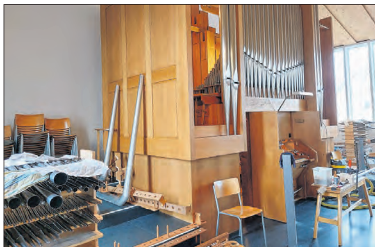
Ziemlich alle Pfeifen müssen bei einer Revision aus der Orgel geholt werden. Die grösste ist fast fünf Meter hoch.
