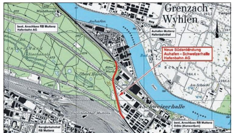
Rot eingezeichnet: die Südanbindung Auhafen Muttenz – Schweizerhalle für den eingleisigen Ringschluss der Hafenbahn.
